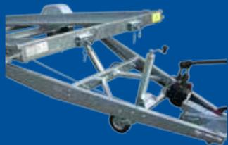
Kit hydraulique de basculement
